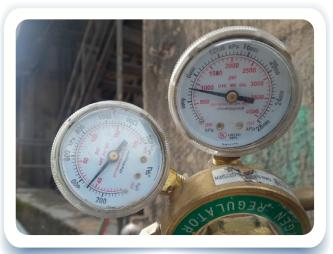
f) Verificar los manómetros y mangueras, válvulas de retroceso faltantes o dañadas y cualquier condición insegura.
