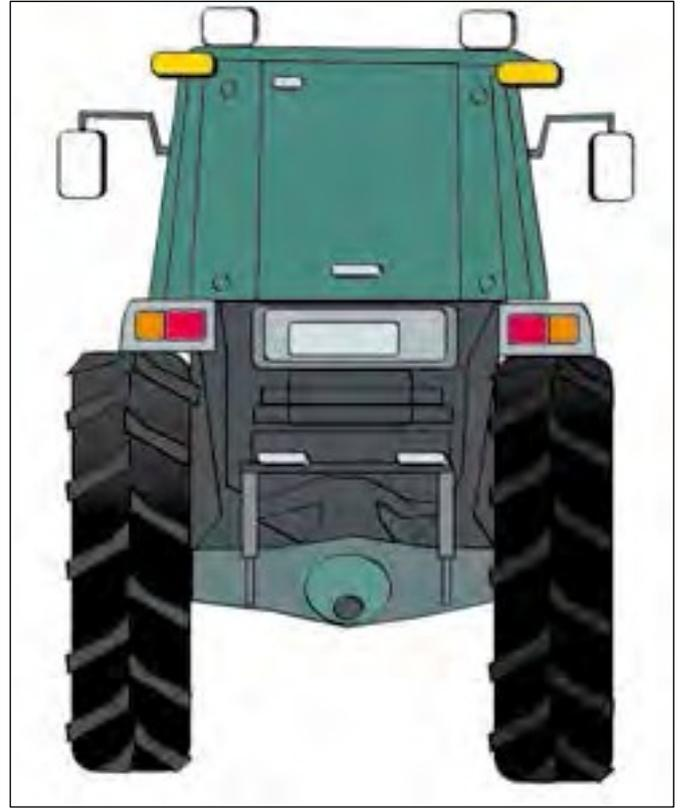
Figura 42b. Retrovisores laterales a ambos lados del , junto con reflectores y luces adicionales.
