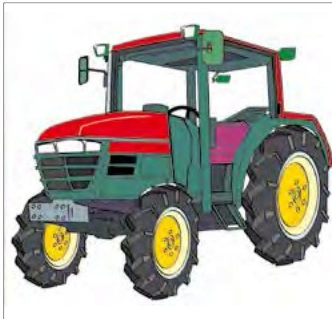
Figura 48b. Los retrovisores pueden aumentar la visibilidad delantera y trasera del conductor.
