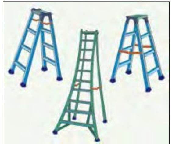
Figura 28b. Existen escaleras de mano de diferentes formas. Utilice escaleras con dispositivos para evitar el desplome repentino.
