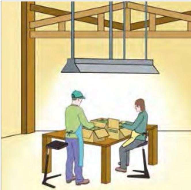
Figura 50a. Reubicar las luces para obtener iluminación suficiente para trabajos de precisión o inspección.
