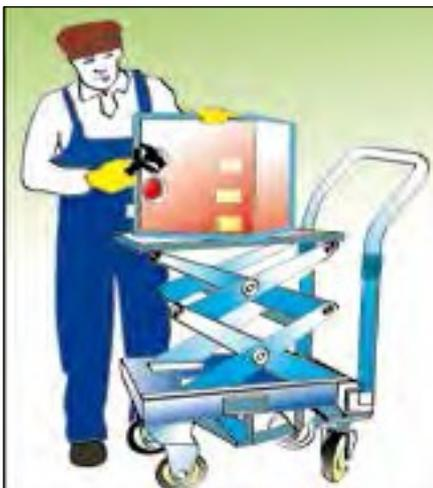
Figura 11d. Dispositivo accionado manualmente para elevar objetos pesados hasta el nivel de trabajo.
