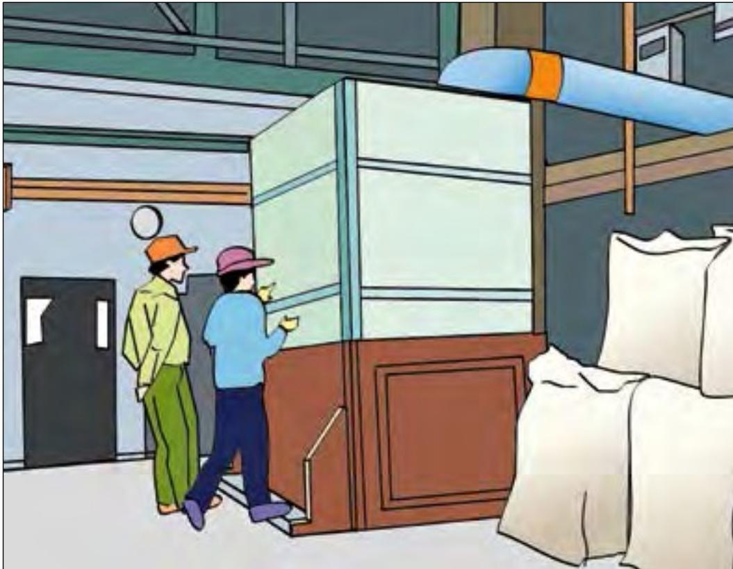
Figura 56a. Elija máquinas que tengan un buen cerramiento combinado con un sistema de escape.
