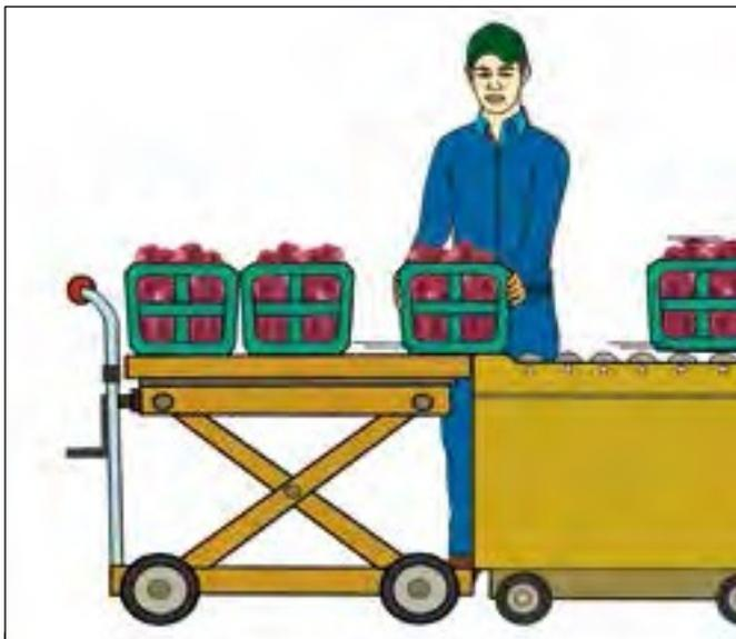
Figura 13b. Reduzca al mínimo las diferencias de altura entre la superficie de la carretilla elevadora y la mesa de trabajo.
