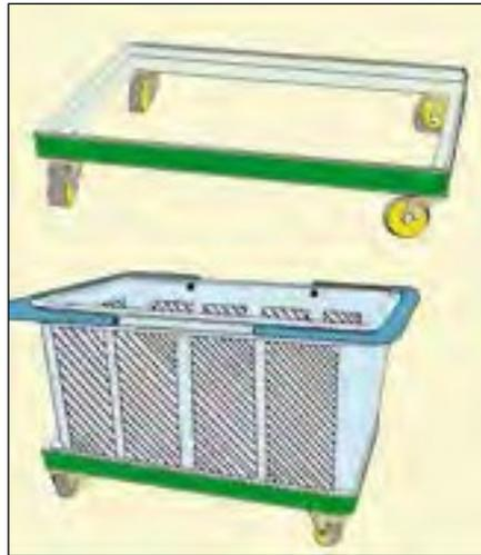
Figura 10b. Coloque las ruedas en los contenedores.
