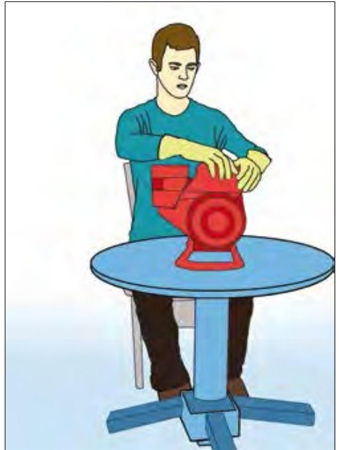
Figura 27b. Un soporte giratorio facilita el trabajo en un elemento desde diferentes direcciones.
