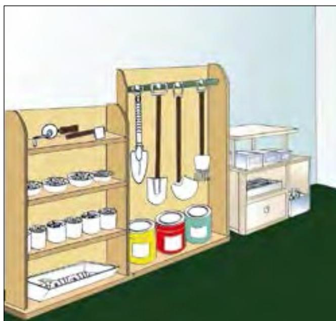
Figura 16d. Estanterías de varios niveles para guardar herramientas agrícolas. Guarde las herramientas pequeñas o los elementos de trabajo en cubos o bandejas especiales con etiquetas claras.
