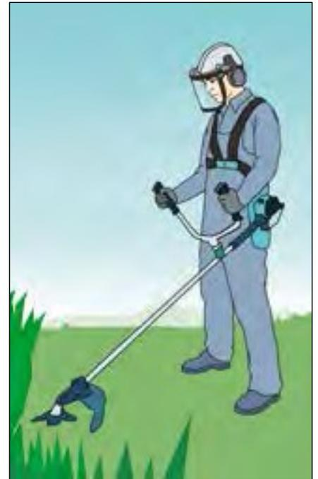
Figura 24b. Utilice una segadora manual para reducir la carga de trabajo de los músculos del brazo y la mano. Coloque asideros resistentes en la herramienta para garantizar un agarre seguro.
