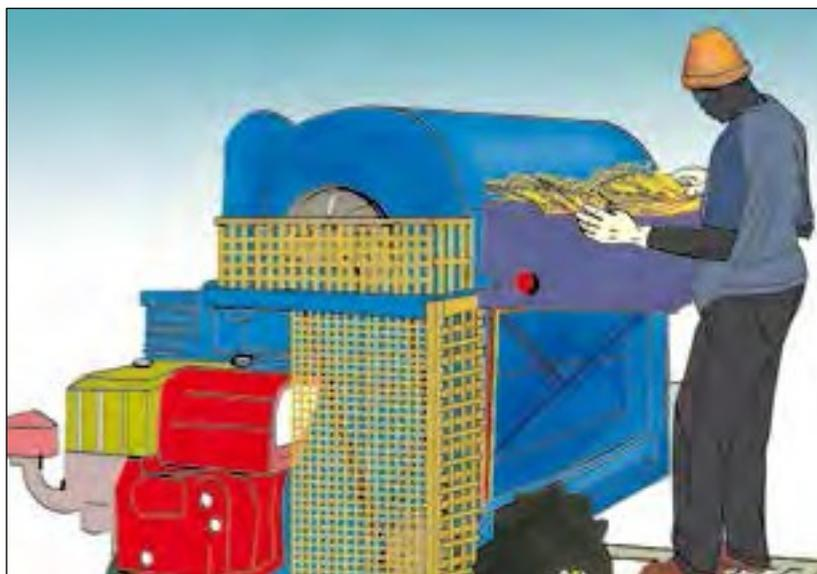
Figura 40a. Haga que el mando de emergencia de la máquina sea claramente visible y colóquelo al alcance del usuario.
