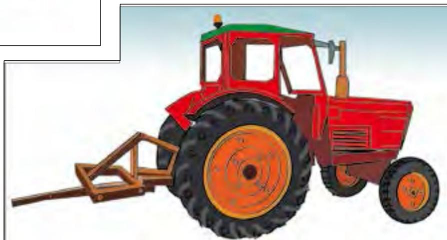
Figura 47b. Las fijaciones en la parte trasera de un vehículo pueden bajar el centro de gravedad y reducir el riesgo de vuelco inesperado.
