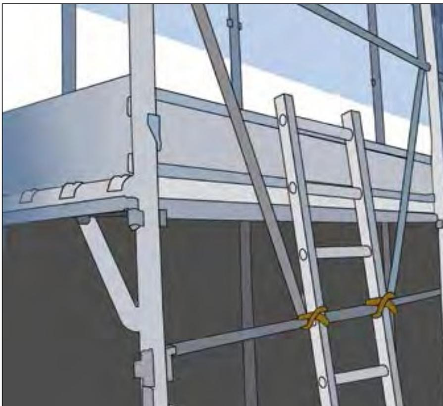
Figura 28c. Las escaleras para llegar a una plataforma elevada deben estar bien sujetas.
