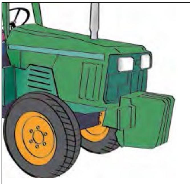
Figura 47a. Añada accesorios pesados en posiciones bajas de un vehículo para bajar su centro de gravedad.
