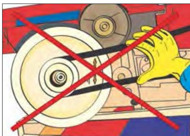
Figura 34d. No toque las piezas móviles de la cuando los protectores estén desmontados para realizar tareas de mantenimiento.
