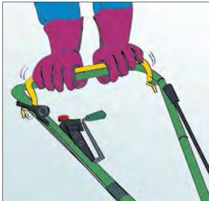
Figura 37b. Seleccione una máquina que se detenga automáticamente al soltar el mando.
