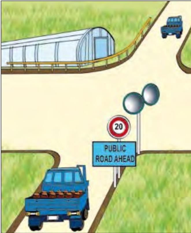
Figura 42a. Colocar señales de advertencia y espejos para garantizar la seguridad del tráfico en los cruces con vías públicas.
