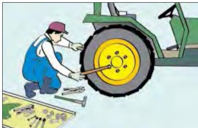
Figura 34b. Preste especial atención a las partes peligrosas de la máquina. Asegúrese de que la máquina está desconectada durante el mantenimiento.
