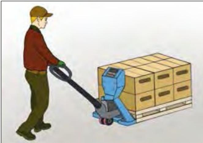
Figura 11a. Dispositivo accionado manualmente para mover palés con artículos pesados.
