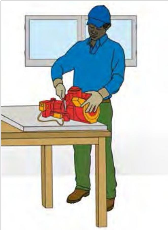
Figura 27a. Ajuste las mesas de trabajo para permitir la altura de trabajo adecuada según el tipo de trabajo que se realice.
