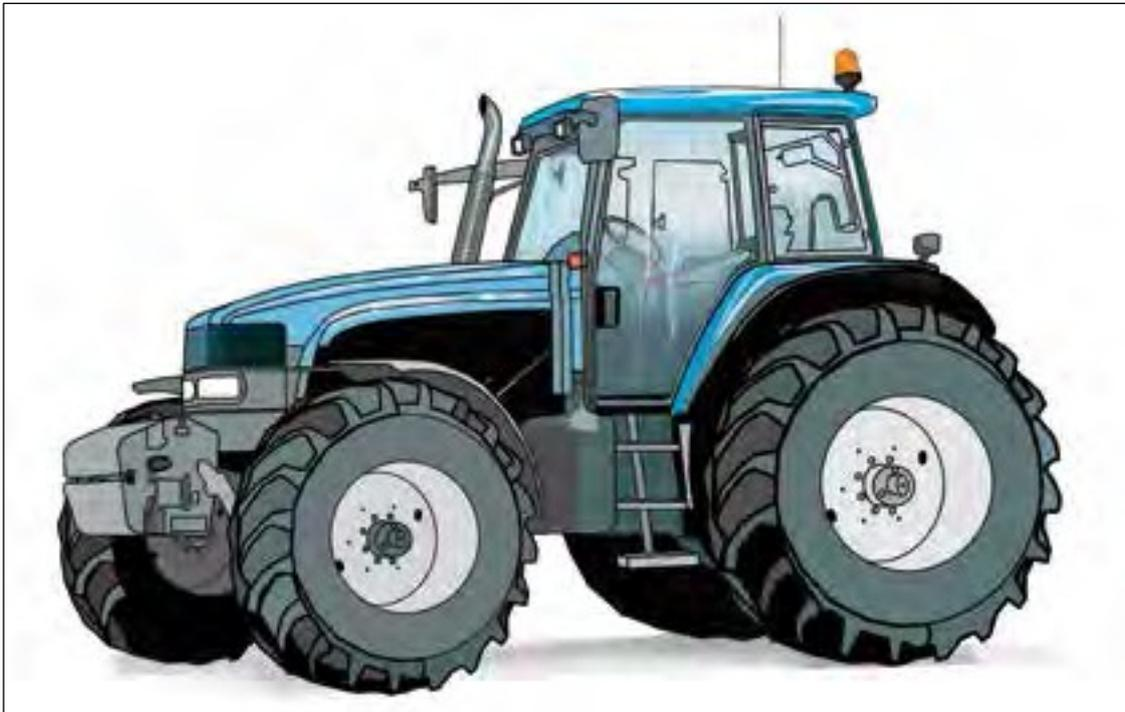
**Figura 45a. Todos los tractores deben disponer de una estructura de protección antivuelco (ROPS) que, combinada con un cinturón de seguridad, evitará la mayoría de los accidentes de los accidentes mortales.**
