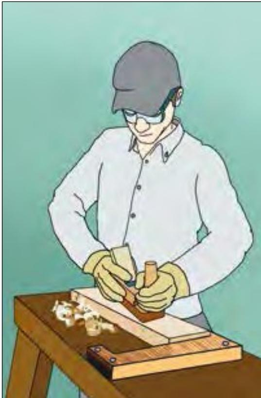
Figura 19a. Accesorio de bajo costo, fabricado en madera, para sujetar piezas de trabajo para el cepillado.
