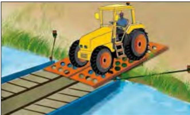
Figura 44c. Proporcionar plataformas estables para formar una ruta para que los vehículos suban y bajen de un barco.
