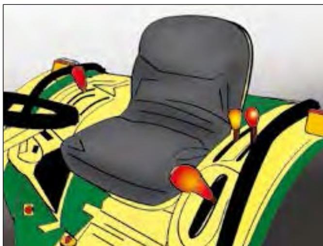
Figura 48c. Los puestos de mando y la disposición de los asientos pueden contribuir a una buena visibilidad del entorno.
