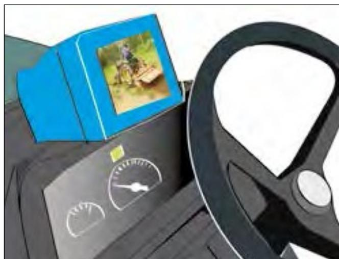
Figura 48d. La visibilidad desde el puesto de conducción puede mejorarse mediante una pantalla especial que muestre la imagen de una cámara situada en la parte delantera o trasera del vehículo.
