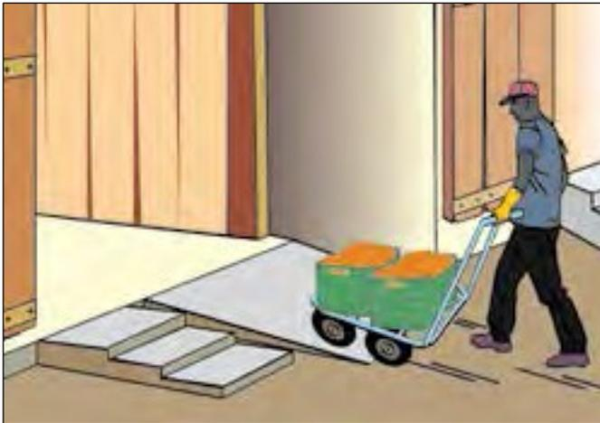
Figura 2a. Prever rampas con una pequeña inclinación para salvar la diferencia de altura repentina en la entrada de un edificio.
