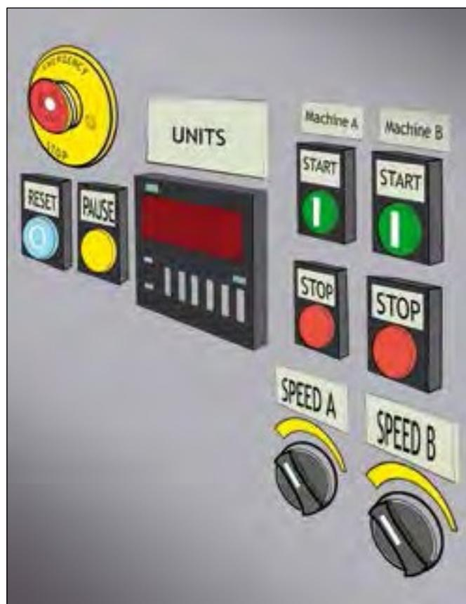
Figura 40c. Un cuadro eléctrico con controles, interruptores y pantallas visibles; todos están claramente marcados en el idioma local.
