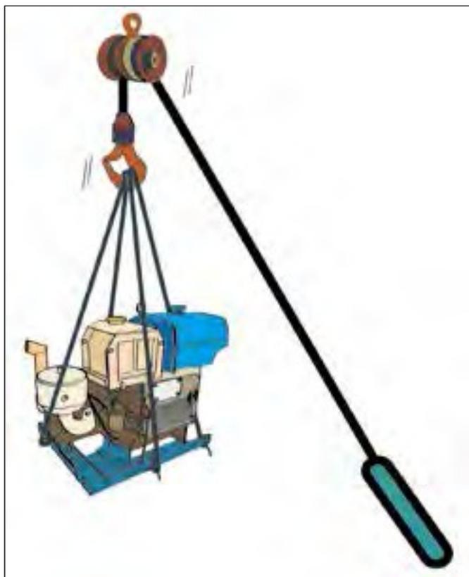
Figura 38a. Fije la carga de forma segura cuando la eleve un polipasto o una grúa.
