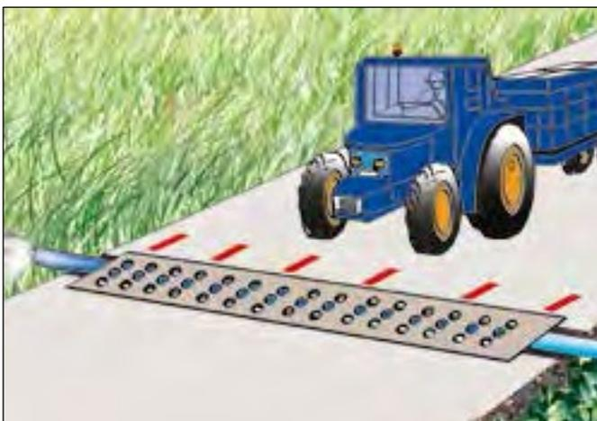
Figura 2c. Elimine las diferencias bruscas de altura en la carretera, para permitir un transporte suave.
