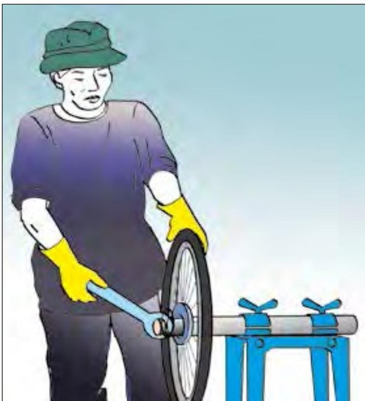
Figura 19c. Utilice una fijación para sujetar los cubos de rueda o los ejes cuando se desmonten para su reparación o mantenimiento.
