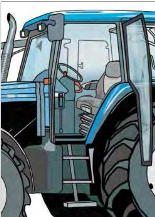
**Figura 45b. Facilidad de acceso al puesto de conducción, asiento adecuado y medidas de protección contra las condiciones meteorológicas y para reducir el ruido y las vibraciones son importantes para evitar deslizamientos, maximizar la comodidad del asiento y evitar errores de manejo.**
