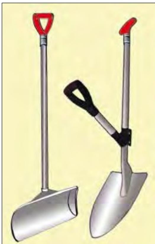
Figura 25d. Los mangos de las herramientas deben tener un tamaño y una fricción adecuados, ya que pueden utilizarse en diferentes condiciones sobre el terreno, a menudo con tiempo húmedo.
