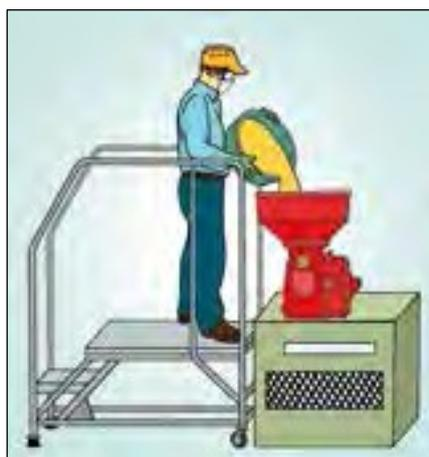
Figura 17d. Ajuste la altura de trabajo utilizando una plataforma estable para los pies que corresponda al nivel de sus codos.
