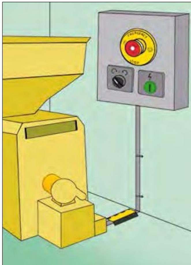
Figura 35b. Los cables eléctricos conectados a la máquina están bien protegidos y claramente etiquetados.
