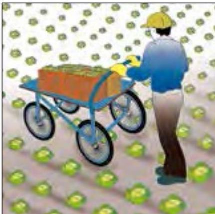
Figura 5b. Utilice ruedas con neumáticos de goma más anchos y bien inflados para facilitar empuje del carro por el campo.
