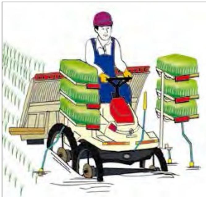
Figura 48a. Asegure la visibilidad desde el asiento del conductor. La buena visibilidad es una de las características de esta trasplantadora de arroz compacta que facilitan su manejo.
