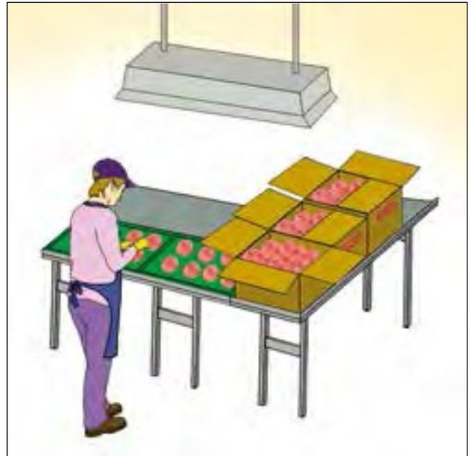
Figura 50b. Asegúrese de que las luces son lo suficientemente brillantes sin causar sombras o deslumbramientos.
