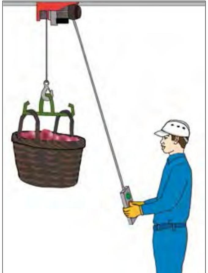
Figura 11b. Polipasto eléctrico de cadena con interruptor de control, utilizado para la elevación eficaz de cargas pesadas.
