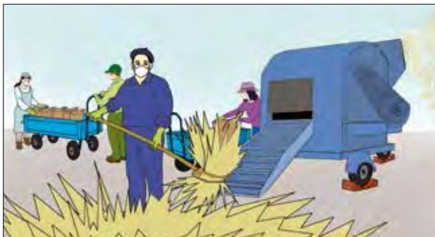
Figura 32a. Utilice cuñas para fijar máquinas con ruedas o máquinas con orugas.
