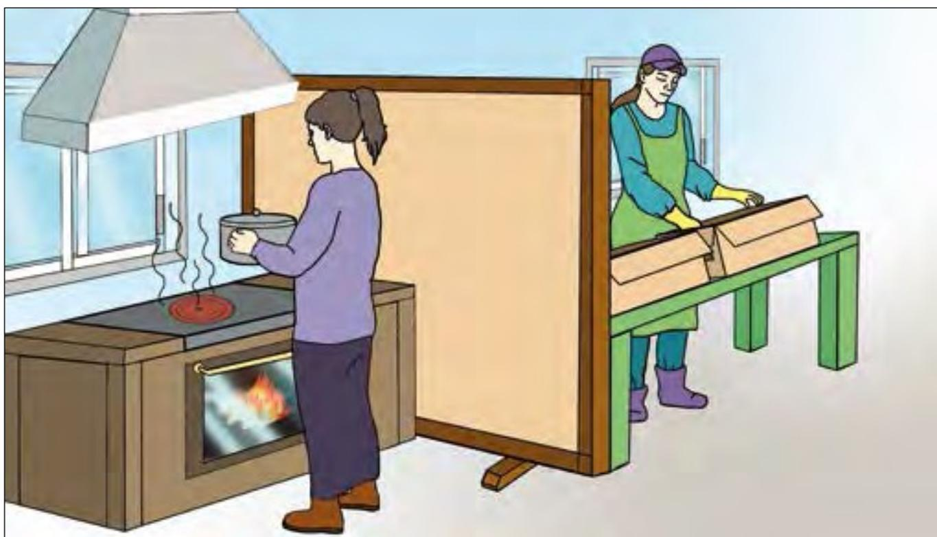
Figura 51b. Utilice pantallas o barreras para proteger a los trabajadores de la radiación térmica procedente de equipos o paredes calientes.
