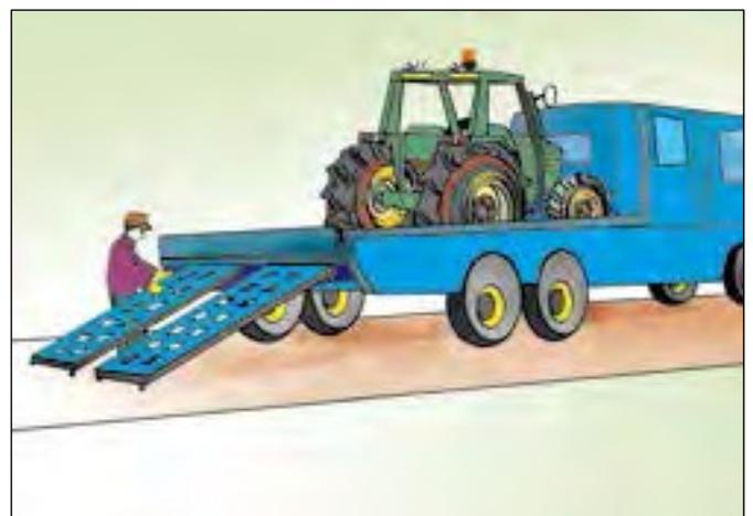
Figura 2f. Utilizar rampas para cargar un vehículo agrícola a un camión.
