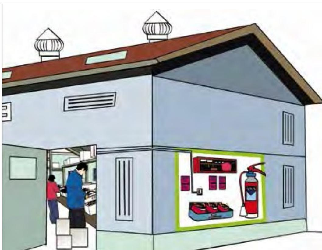
Figura 58. Asegúrese de que los tipos apropiados de extintor de incendios se colocan cerca de una zona de trabajo donde hay un riesgo de incendio.
