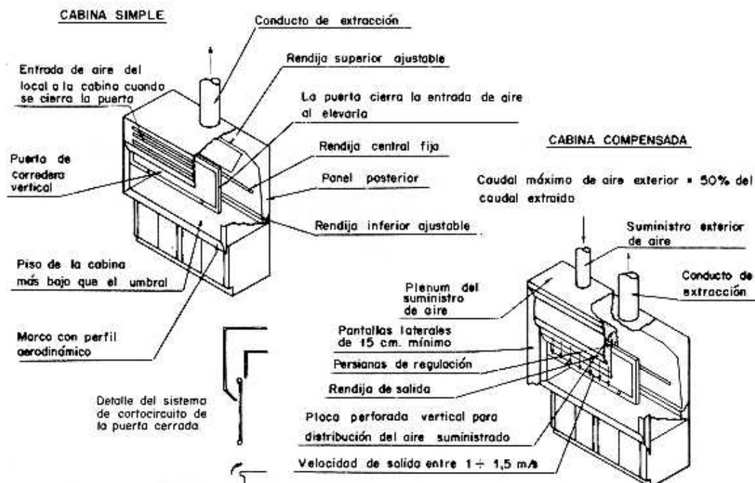
El caudal de aire que debe extraerse de una cabina de este tipo varía, en función de los materiales que se manipulan en ella, desde 1300 m<sup>3</sup> por cada m<sup>2</sup> de abertura para productos corrosivos o moderadamente tóxicos, hasta 2300 m<sup>3</sup>/h. por m<sup>2</sup> de abertura para productos muy tóxicos (TLV inferior a 0,1 mg/m<sup>3</sup> ó 10 ppm).
