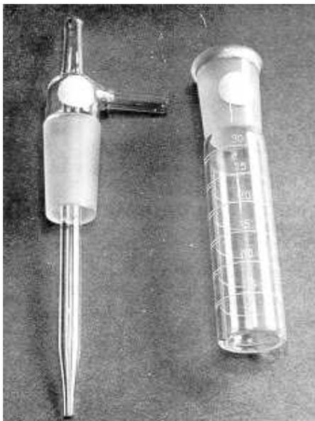
**Fig. 1: Componentes impinger**
