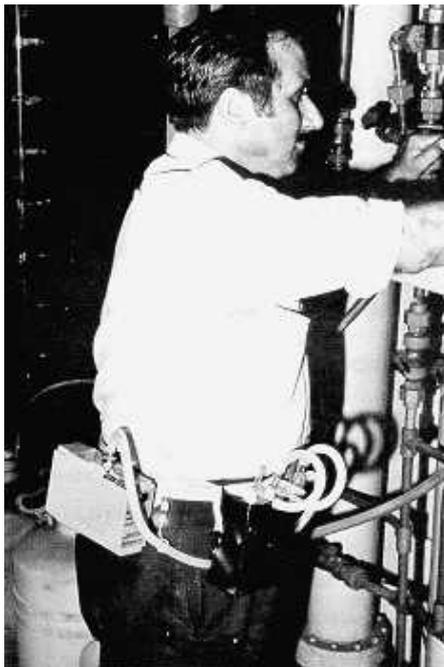
**Fig .3: Toma de muestra con impinger**
