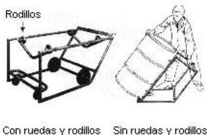
**Fig. 3: Estructuras de cuna metálicas**
