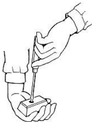
Fig. 14: Sujeción incorrecta de una pieza a atornillar
