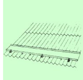
Fig. 8: Pasarela apoyada sobre tres topes de seguridad
