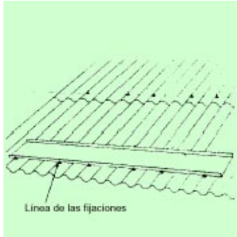
Fig. 6: Pasarela instalada perpendicular a la pendiente
