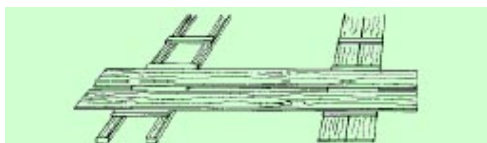
Fig. 23: Pasarelas de circulación
