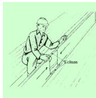
Fig. 4: Ensamblaje de pasarelas
