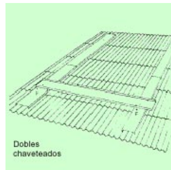
Fig. 10. Chaveteado sobre una pasarela paralela
