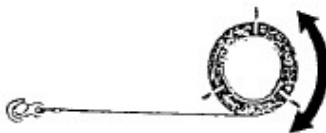
Figura 14. Almacenamiento de los cables
