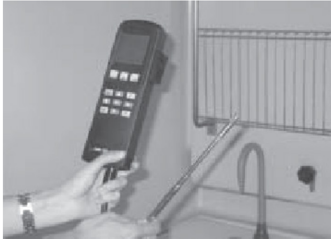
Figura 3 Lectura con anemómetro en el punto de medida
