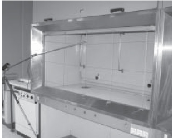
Figura 5 Procedimiento de lectura sin alterar la velocidad de aspiración
