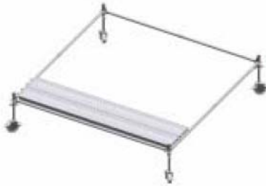
Figura 3 Montaje de pies, brazos, diagonales y plataformas del primer nivel
