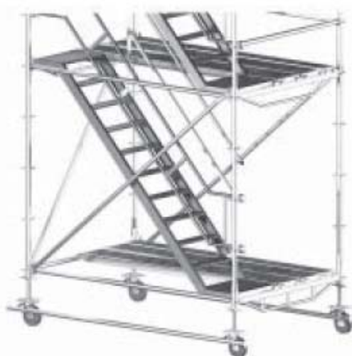
Figura 16 Ruedas unidas mediante tubo para desplazamientos rectos
